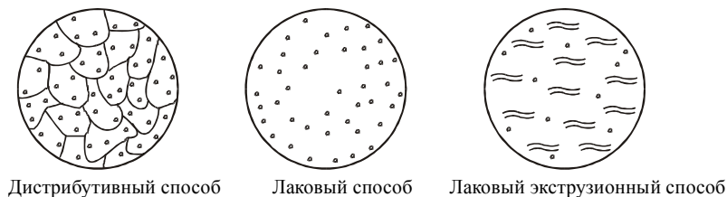
Рис. 1. Структура капли порохового лака.
