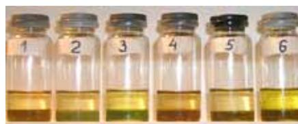
Рис. 12. Образцы, полученные в результате осуществления процесса безкаталитической переэтерификации триглицеридов жирных кислот (рапсовое масло) в среде сверхкритического метанола. Характеристики образцов представлены в табл. 11.
