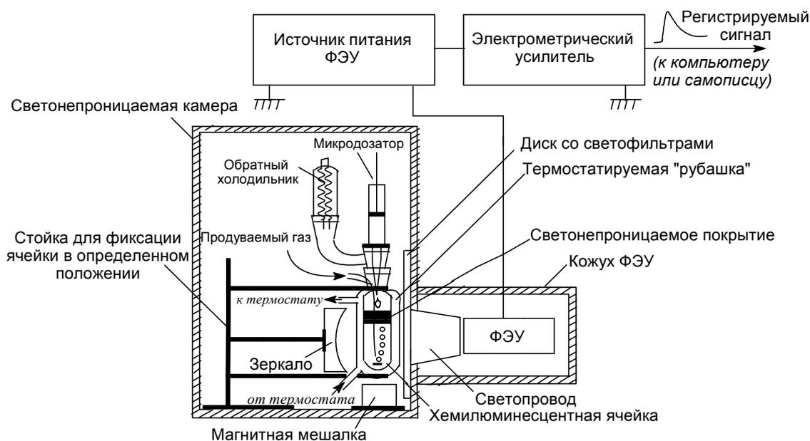
**Рис. 1.** Принципиальная схема фотометрической установки для регистрации слабых световых потоков.
