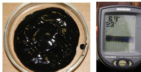
Рис. 4. Образец грунта и данные эхолота первого типа грунта
