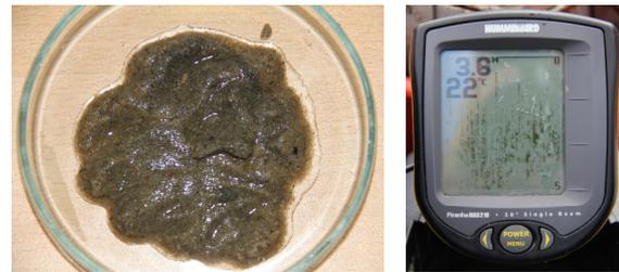
Рис. 8. Образец грунта и данные эхолота третьего типа грунта
